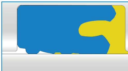
Abb. 32 - Pic.32: BLF® bei 400 bar / BLF® in pressure 400 [Bar]
